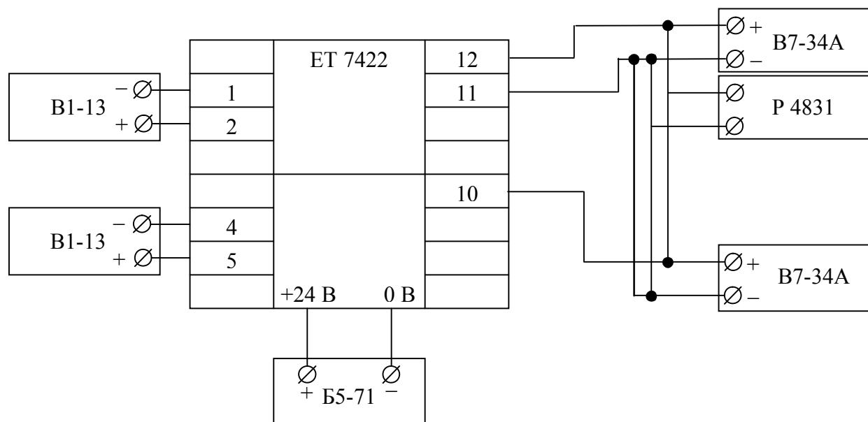
**Рисунок А.1 – Схема проверки погрешности преобразования
