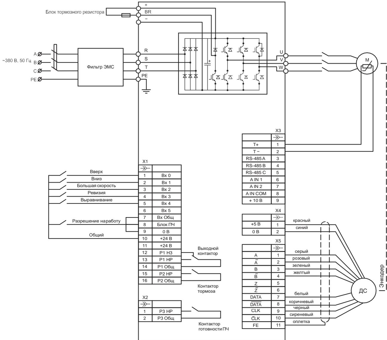
\* приведена общая схема подключения. Схемы подключения преобразователей частоты к конкретным станциям управления приведены в руководстве по эксплуатации.
